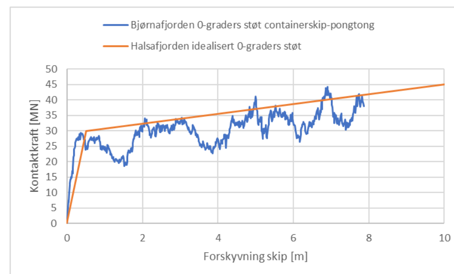
Figur 2-12: Kraft-forskyvningskurve, skipsstøtanalyse Bjørnafjorden fase 5 (blå) og idealisert for Halsafjorden (oransje).
